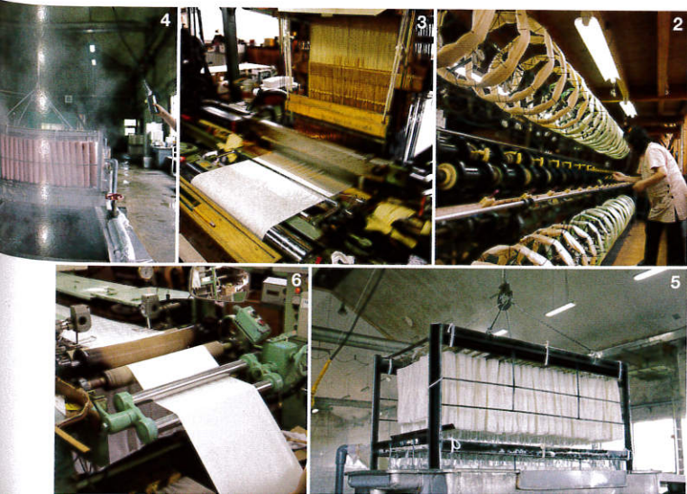
1 地紋が際立つ紋意匠縮緬 2 かせになった生糸を糸枠に巻き取ります。その後、緯糸に撚りをかけます 3 ジャカード機で織ります 4 白生地を精練液の入った水槽に入れて精練します。最初に粗練りしてから水洗します 5 さらに本練りをして水洗、漂白後に水洗、仕上げ練りして水洗と繰り返します 6 縮んだ幅や丈を整えます
