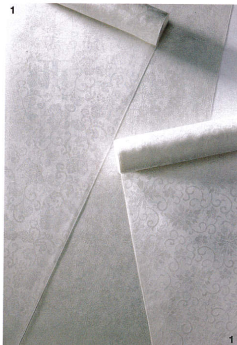
1 地紋が際立つ紋意匠縮緬 2 かせになった生糸を糸枠に巻き取ります。その後、緯糸に撚りをかけます 3 ジャカード機で織ります 4 白生地を精練液の入った水槽に入れて精練します。最初に粗練りしてから水洗します 5 さらに本練りをして水洗、漂白後に水洗、仕上げ練りして水洗と繰り返します 6 縮んだ幅や丈を整えます
