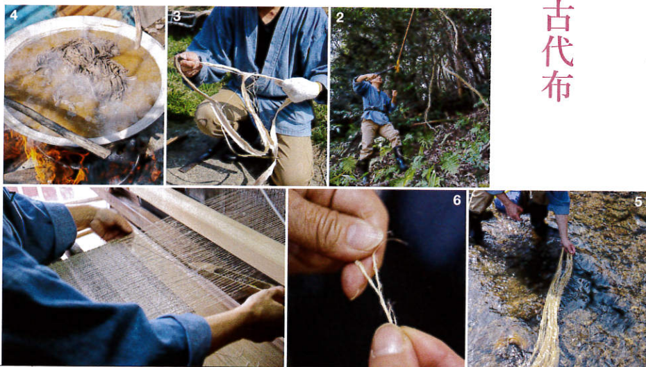
1 藤布の帯 2 4月から6月に山に入り、藤蔓を採取 3 乾燥しないうちに木槌で叩き、柔らかくして表皮をはぎ、アラソを取り出して乾燥 4 アラソを水に浸けて木灰で4時間炊きます 5 清流に浸け、竹の器具で不純物をしごき落として白い繊維に 6 米糠を溶いた湯に入れて柔らかくした繊維を裂き、撚り合わせて糸に 7 糸に撚りを掛け、経糸に糊付けて織ります
